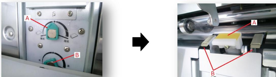
旋钮 (A) 调节分纸片 (A) 的强度, 旋钮 (B) 调节进纸挡纸块 (B) 的高度。通常使用 (A) 旋钮调节分纸压力, 旋钮 (B) 转至最左边。
