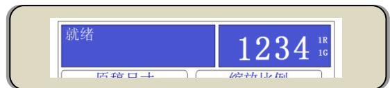
输入的张数会在显示屏上显示，印刷中显示的是剩余张数 ( 减法运算方式 )。
