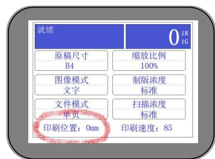
通过操作部的[印刷位置]按钮进行调整。无论机器是在停止状态还是动作状态，进行调整时以中心为基准，移动刻度显示在显示器左下侧。
