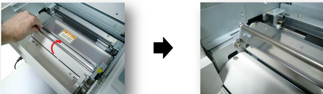
v ) 取下蜡纸卷芯上的左右蜡纸筒支架，安装在新的蜡纸芯上。
